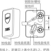
● 在墙壁上合适位置钻两个 \$ 9mm、深80mm的孔,要求两孔在同一竖直线上,距离见上表中孔距L2。把两个钢膨胀螺栓分别插入两个孔中,然后依次将地线盒底盖、接地环套设在两个钢膨胀螺栓上,固定旋紧,再将地线盒线夹、地线盒安装在地线盒底盖上。
